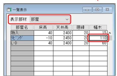
\* P.4 の操作⑤で床高を 50mm 下げた分、幅木の位置も下がるので、幅木の上端を隣接する L・D と合わせるため、幅木の高さ 60mm に 50mm を追加し、110mm とします。
