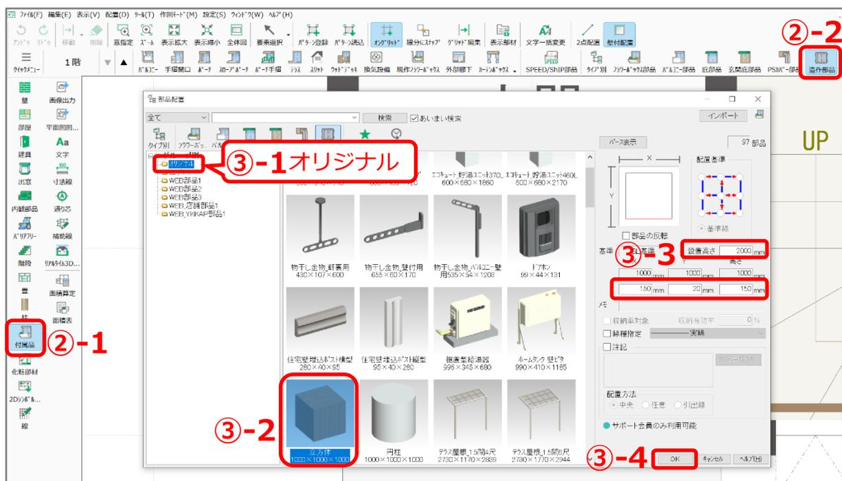
④ 入力モードが (壁付配置)になっていることを確認し、配置したい位置で起点—終点をクリック
