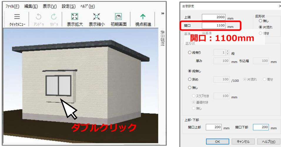
(リアルタイム3Dビューア) で出窓部品をダブルクリックすると、付属品設定の画面が表示され、出窓部品の上端高さの確認・変更、建具高さを確認できます。出窓部品の高さは部品ごとに固定のため変更はできません。
