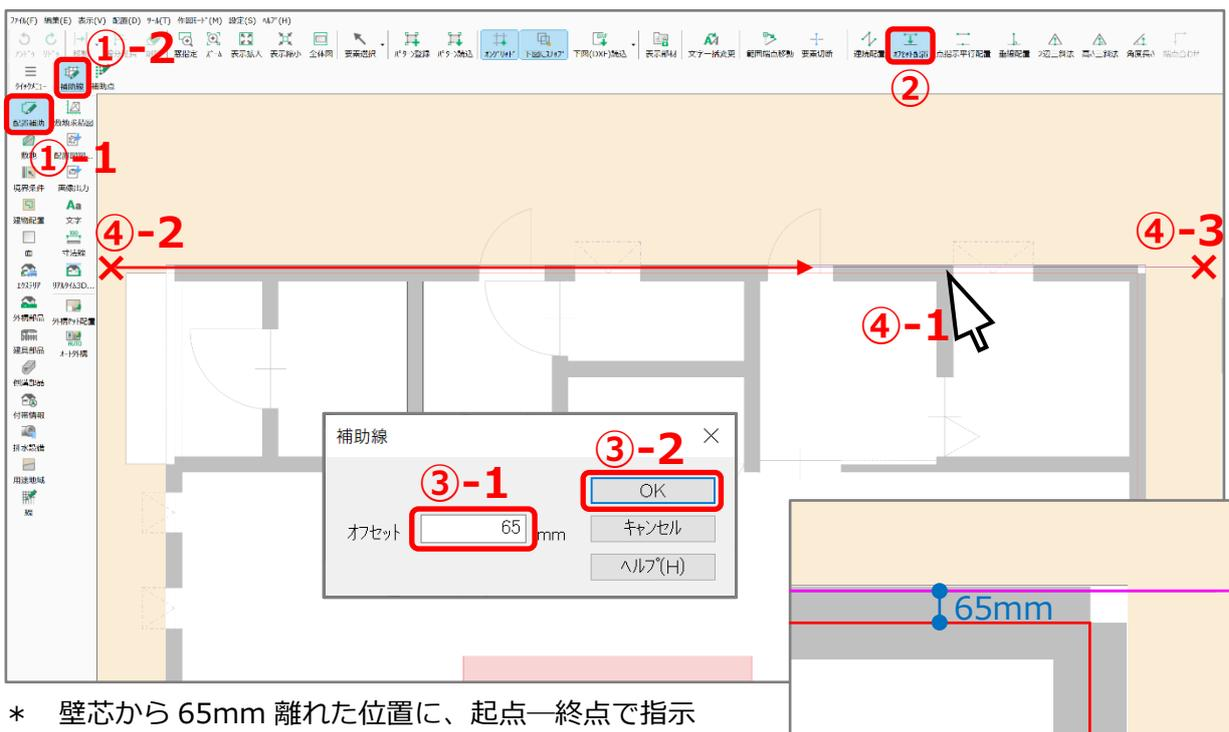
\* 壁芯から 65mm 離れた位置に、起点—終点で指示した長さで補助線が入ります。
